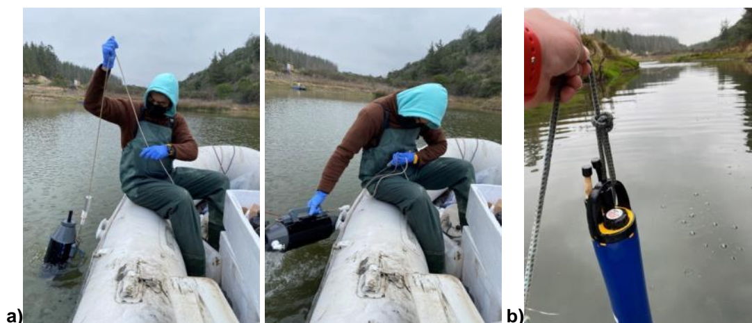
Figura 2. Equipamiento para el muestreo de columna de agua. a) botella oceanográfica Niskin y b) CTD YSI EXO 2.
