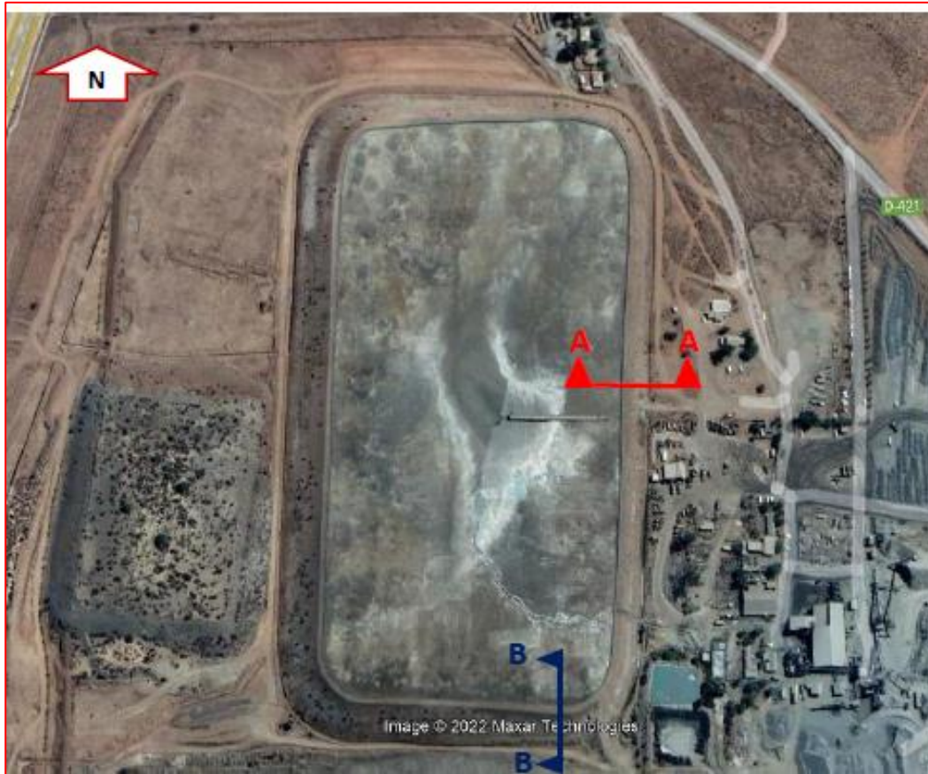
Figura 7: Perfiles considerados para el análisis de estabilidad física del embalse de relaves.
