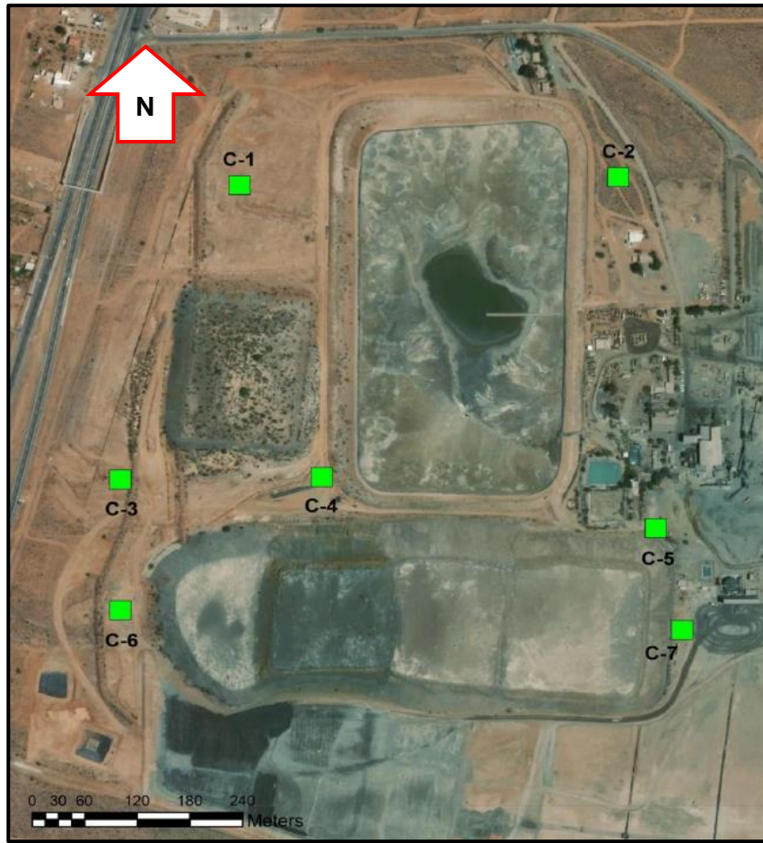
Figura 1: Disposición de calicatas en suelo de fundación.
