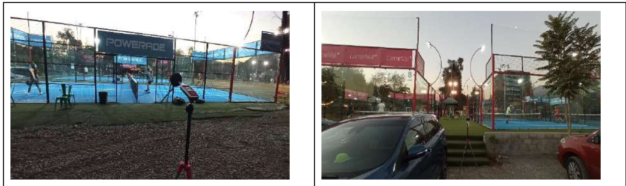
Imagen N° 6: Fuente ITO Asesorías, Fotografía del proceso de medición de ruido generado por canchas de Padel Club Conecta La Dehesa
