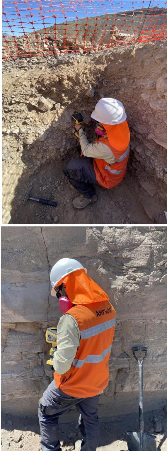
**Figura 3-5:** Adquisición de datos en terreno con equipo FRX portátil.
