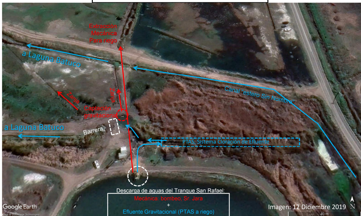
Figura N°2.2.a: La PTAS descarga históricamente sus aguas al Tranque San Rafael. Desde el Tranque San Rafael; parte del volumen descargado por la PTAS es extraído mecánicamente para aprovechamiento antrópico y el remanente es descargado gravitacionalmente a una quebrada o Bajo Natural Sin Nombre, por el cual escurre hacia la laguna. Fuente: Elaboración propia sobre imagen Google Earth del 17 diciembre 2019
