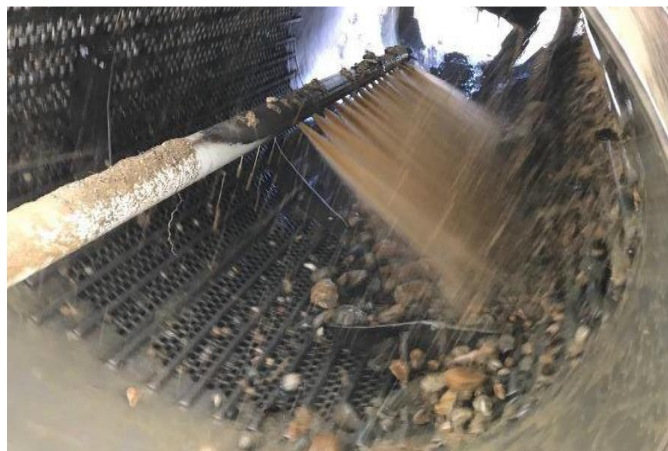
(Foto 7: Vista del interior del Trommel)
