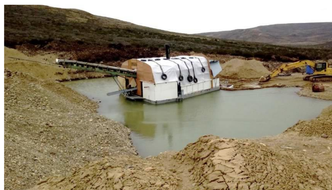
(Foto 4. Planta Móvil-flotante dentro del reservorio)
