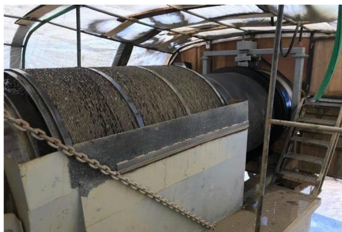
(Foto 6: Trommel giratorio para separación de sólidos)
