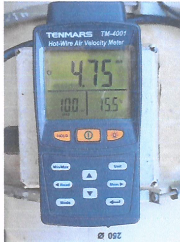
Ilustración 6: Medición de velocidad en Punto de Muestreo
