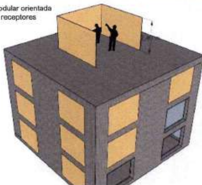
FIGURA 9. EJEMPLO Y ESQUEMA DE IMPLEMENTACIÓN DE CIERRES MODULARES EN LOSA DE AVANCE.
