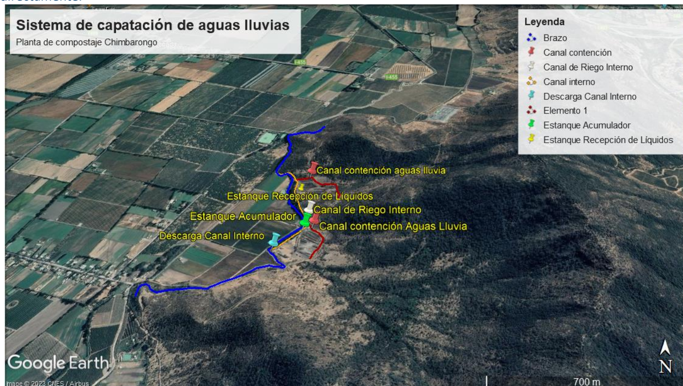
Imagen N°7: Sistema de captación de aguas lluvias
