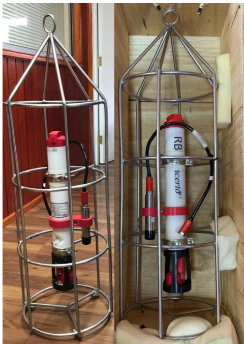
Fig. 4. Se muestran dos imágenes del equipo CTD RBRconcerto para medir los diferentes parámetros físicos en la columna de agua (profundidad, temperatura, conductividad, salinidad y oxígeno disuelto como concentración en mg/L y porcentaje de saturación).
