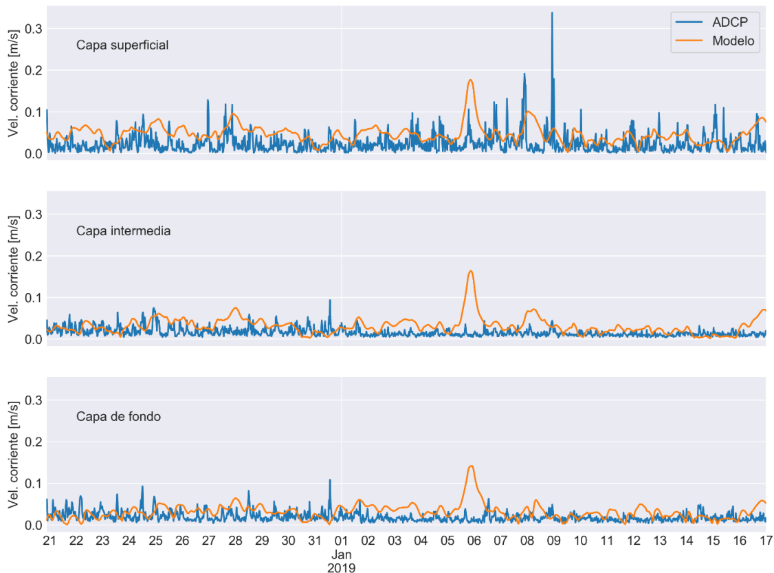
Figura 4-12: comparación entre registros de velocidad de corriente del ADCP y resultados del modelo hidrodinámico.
