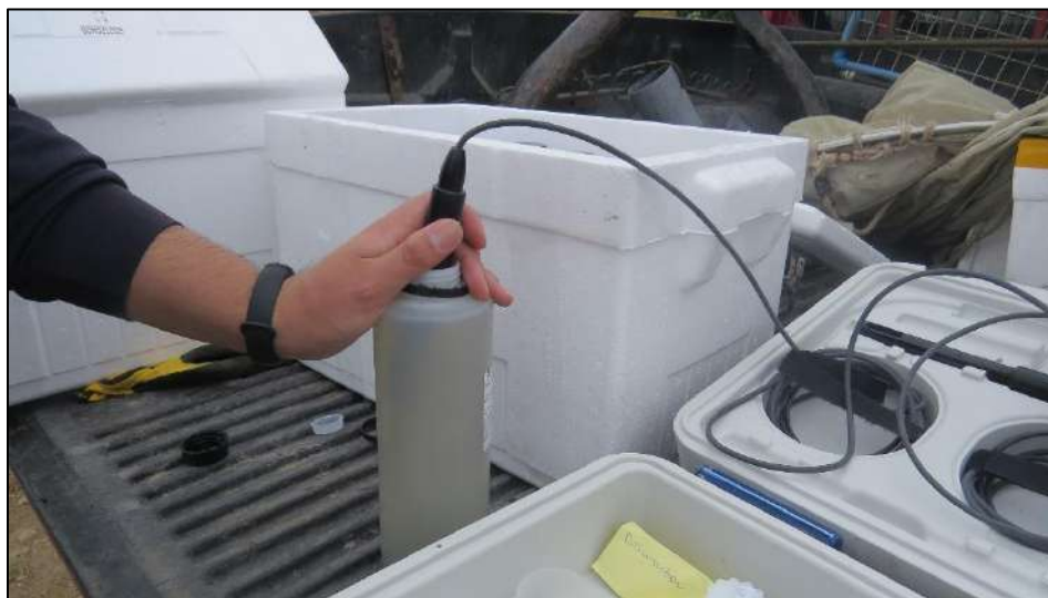
Fotografía 2-1: Sonda potenciométrica WTW. ET Olmué, Ilustre Municipalidad de Olmué, Sector Planta de Tratamiento de Aguas Servidas, Región de Valparaíso. Febrero 2022.
