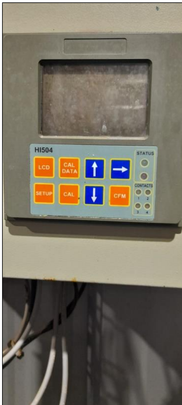
Imagen N°1: Fotografía de referencia medidor de potencial de oxido reducción (ORP) en línea
