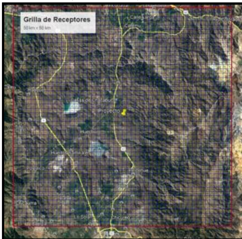
Figura 3.4: Emplazamiento grilla de receptores
