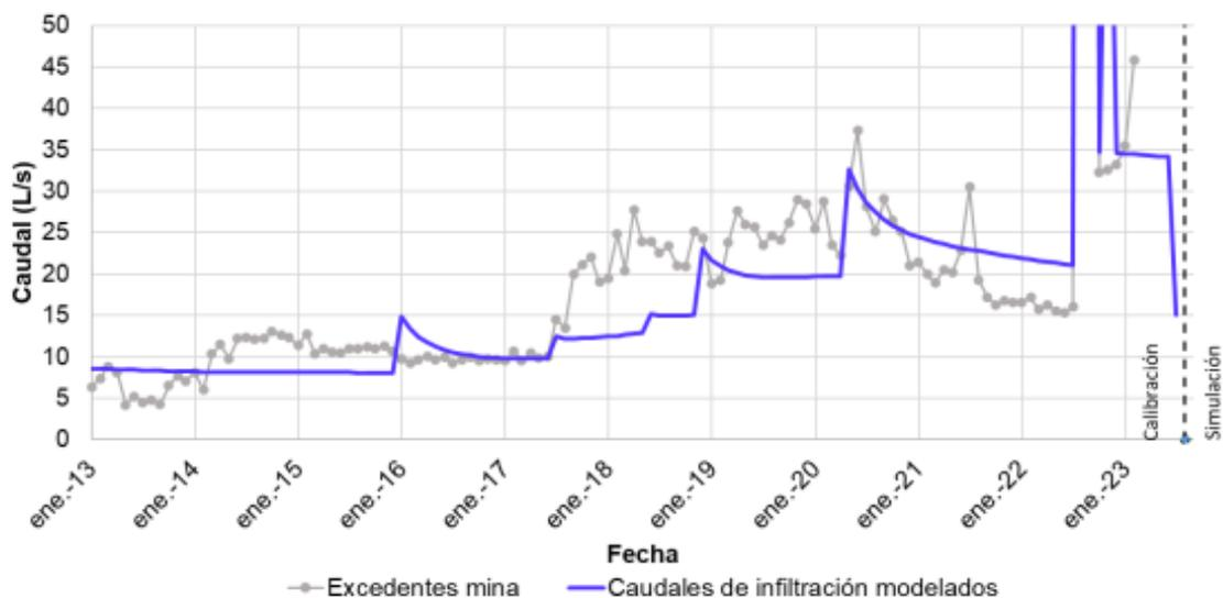
Fig. 5.9: Gráfico del caudal de infiltración registrado en la mina pre y post socavón (obtenido de obtenido de figura 4-7 del documento “ANEXO 2 – Modelo numérico hidrogeológico Alcaparrosa – IT-02 022-08342” de agosto 2023)
