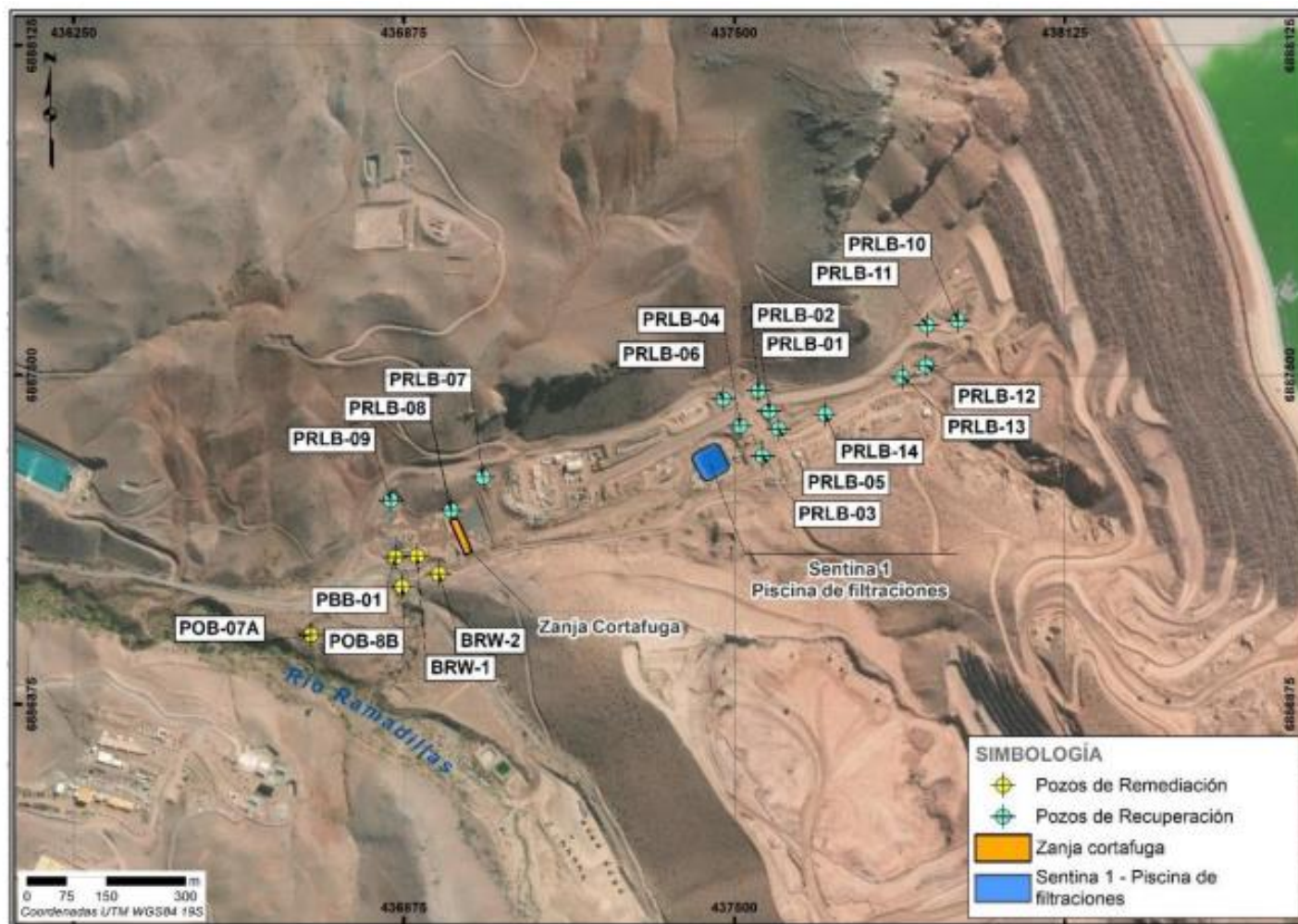
Figura 1. Pozos de remediación (5) y pozos de recuperación (14) de quebrada La Brea
