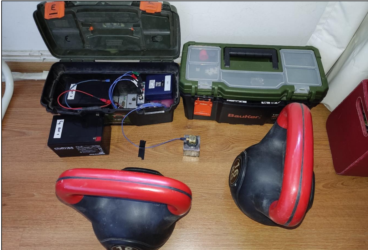
Ilustración 5. Montaje medición triaxial de velocidad de vibración.
