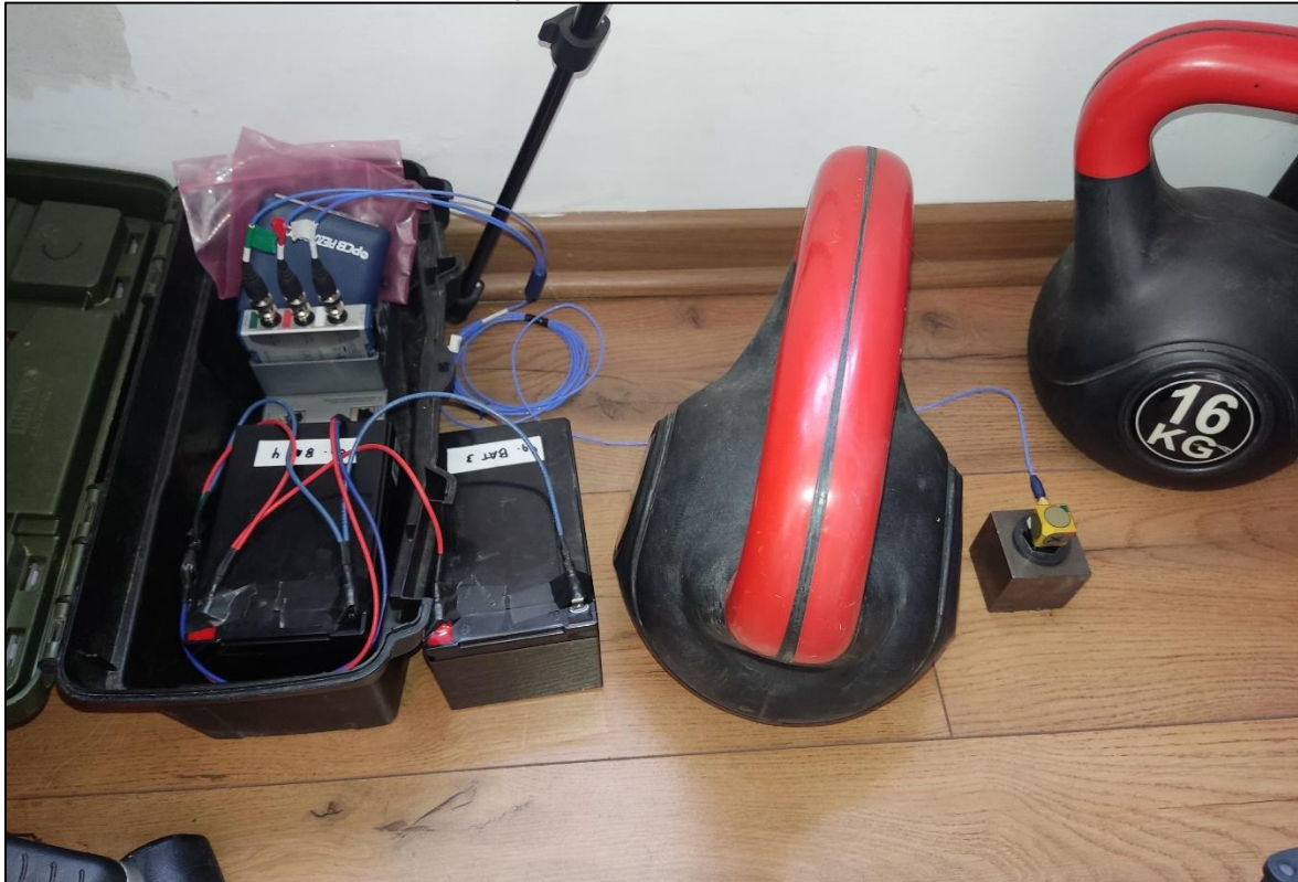
Ilustración 5. Montaje medición triaxial de velocidad de vibración.
