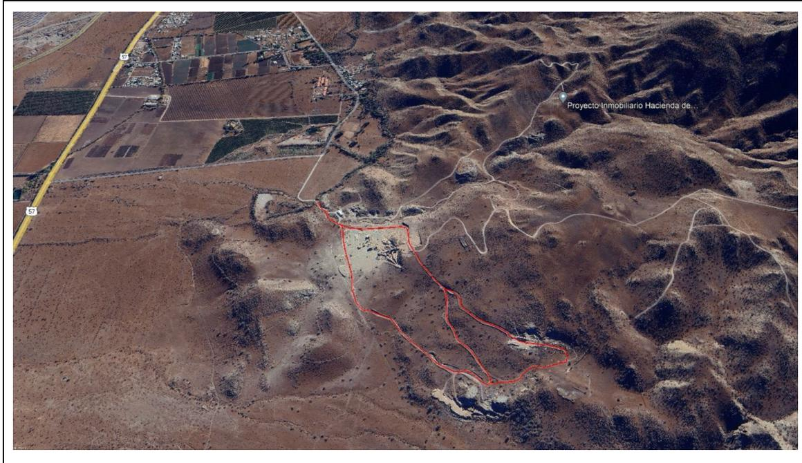
**Figura 7: Rutas para aplicar estabilizador de camino en reemplazo de la humectación**
