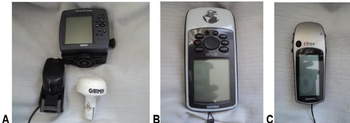
**Figura 2. Equipos de posicionamiento geográfico que se pretenden utilizar en el proyecto. A) GPS 178 Sounder; B) GPS 76; C) GPS eTrex Vista. Todos marca GARMIN®**
