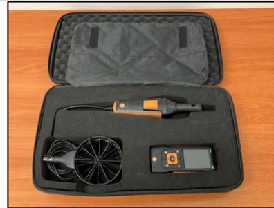
**Anemómetro de paleta para medición de flujos.**
