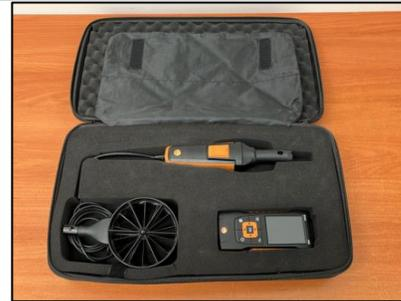
**Anemómetro de paleta para medición de flujos.**
