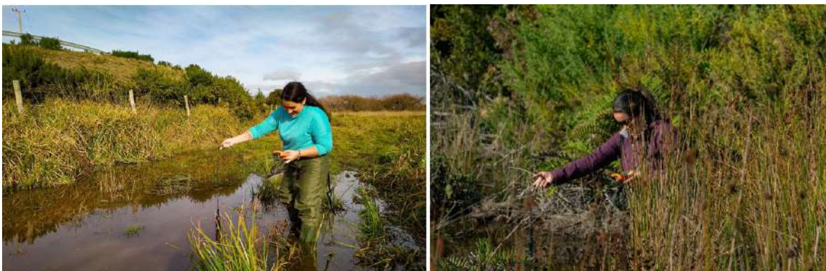
Figura 14. Toma de muestras de parámetros de calidad de agua mediante sonda multiparamétrica. Fuente: Elaboración propia.
