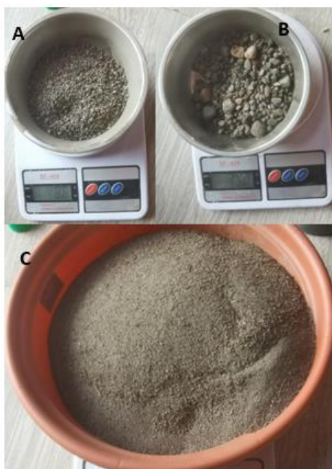
Figura 16: Depósitos volcanoclásticos tamizados; (A) Granos 1 < x < 4.5\text{mm} / (B) Granos x > 4.5\text{mm} / (C) Granos < 1\text{mm}
