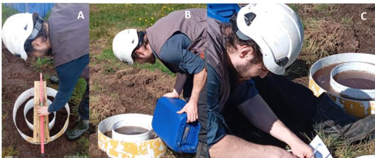
Figura 6: (A) Nivelación de cilindros / (B) Relleno de agua cuando queda menos del 10% del total de agua / (C) Recopilación de datos medidos en el tiempo
