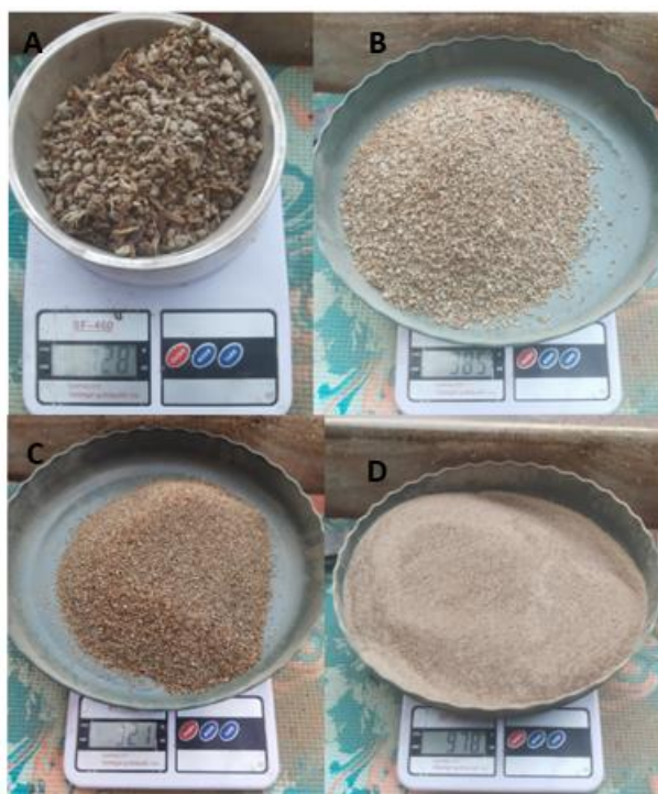
Figura 13: División de granos de depósito de caída, según el tamaño de sus granos. (A) Lapilli >4.5\text{mm} / (B) Lapilli fino 4.5 > x > 1\text{mm} / (C) Ceniza 1 > x > 0.6\text{mm} / (D) Ceniza <0.6\text{mm} .
