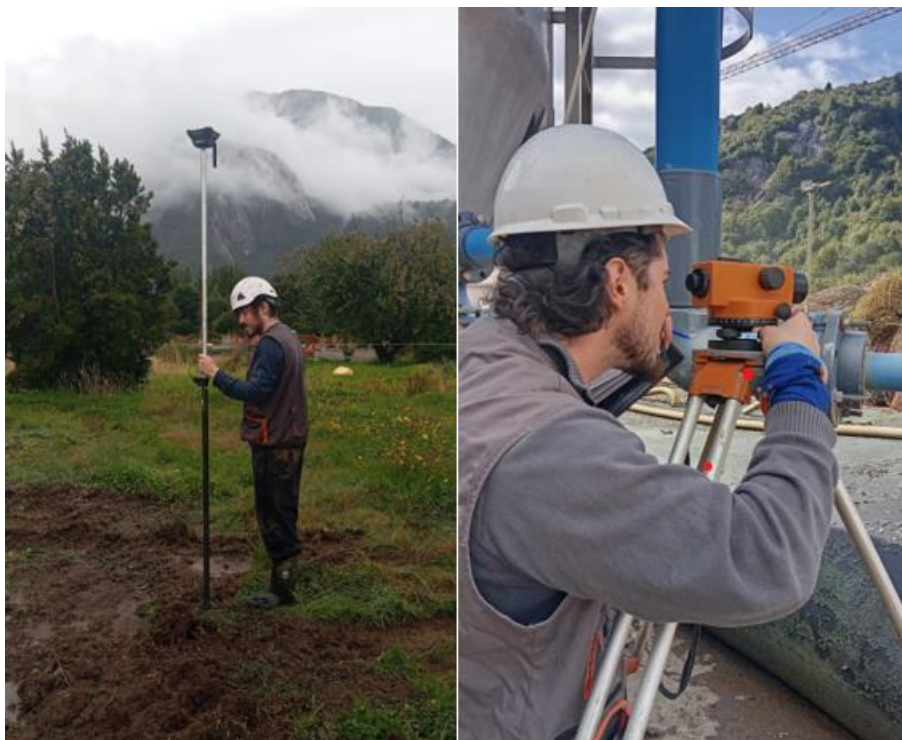
Figura7: Uso de metodologías topográficas para determinar ubicación o diferencias de altitud. Figura derecha muestra método de utilización GPS RTK Emlid rs+, para determinar coordenadas geográficas, figura izquierda, muestra utilización de nivel óptico topográfico para determinar diferencias de alturas.
