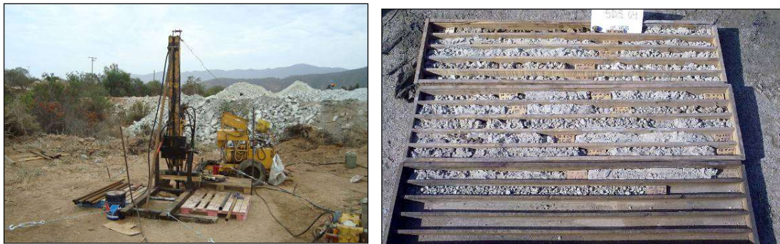
Figura 4.14: Ejecución y resultado de sondeos geotécnicos.
