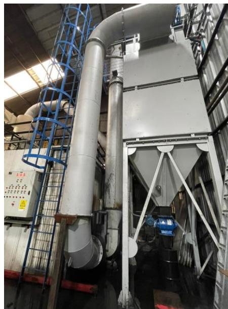
Los gases filtrados por el sistema de abatimiento son evacuados del filtro de mangas mediante un ventilador que los libera hacia la atmósfera. Cabe mencionar, que aguas abajo del ventilador está la plataforma que permite inspeccionar el equipo y realizar los estudios isocinéticos.
