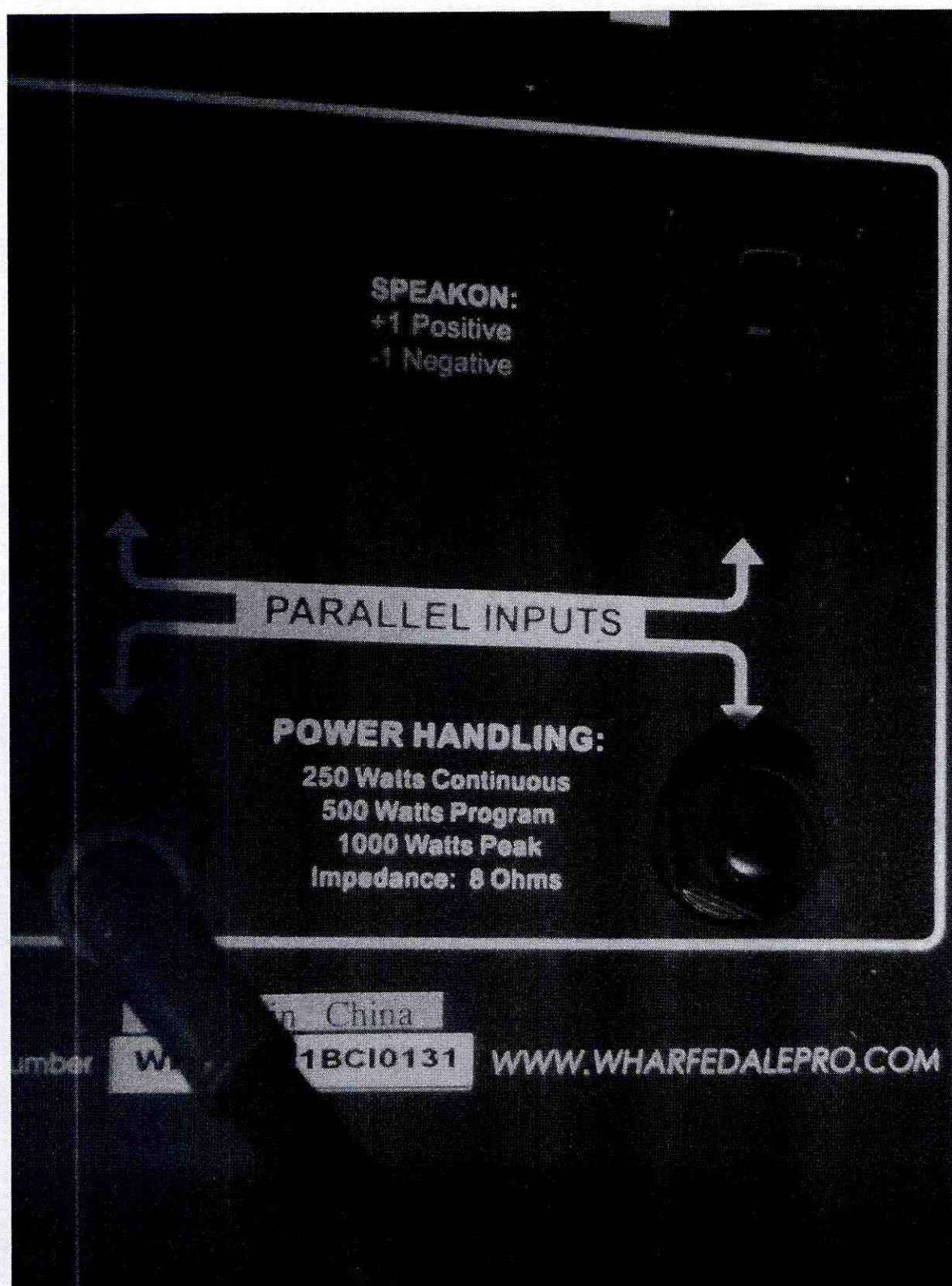
FOTO 3: Detalle de marca y potencia de ambos parlantes 06/08/2025
