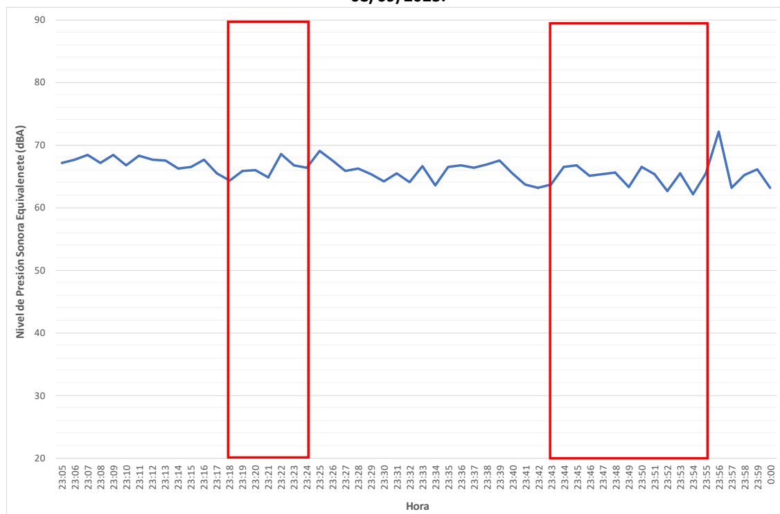
Figura 6. Gráfico de medición continua de ruido en salón principal primer piso, durante la evaluación el día 08/09/2025.
