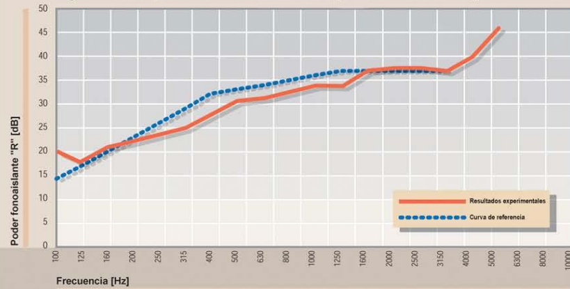
Diagrama del poder fonoaislante del panel MEC W.A. sp 50 mm.
