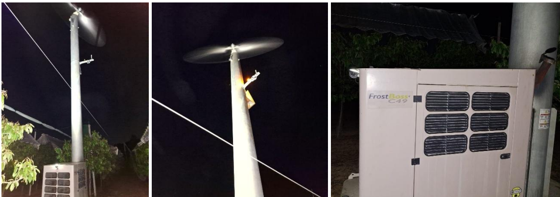
Figura 1 – Torres de control de heladas al interior de predio Parcelación La Poza
