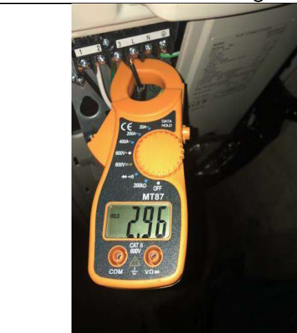
Puesta en marcha equipo y consumo compresor
