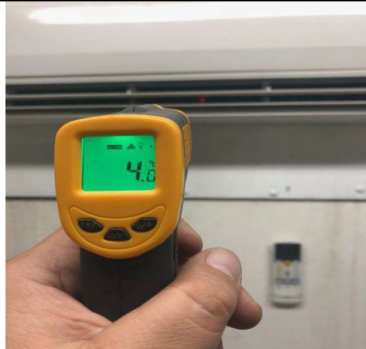
Tº inyeccion equipo 4.0°C
