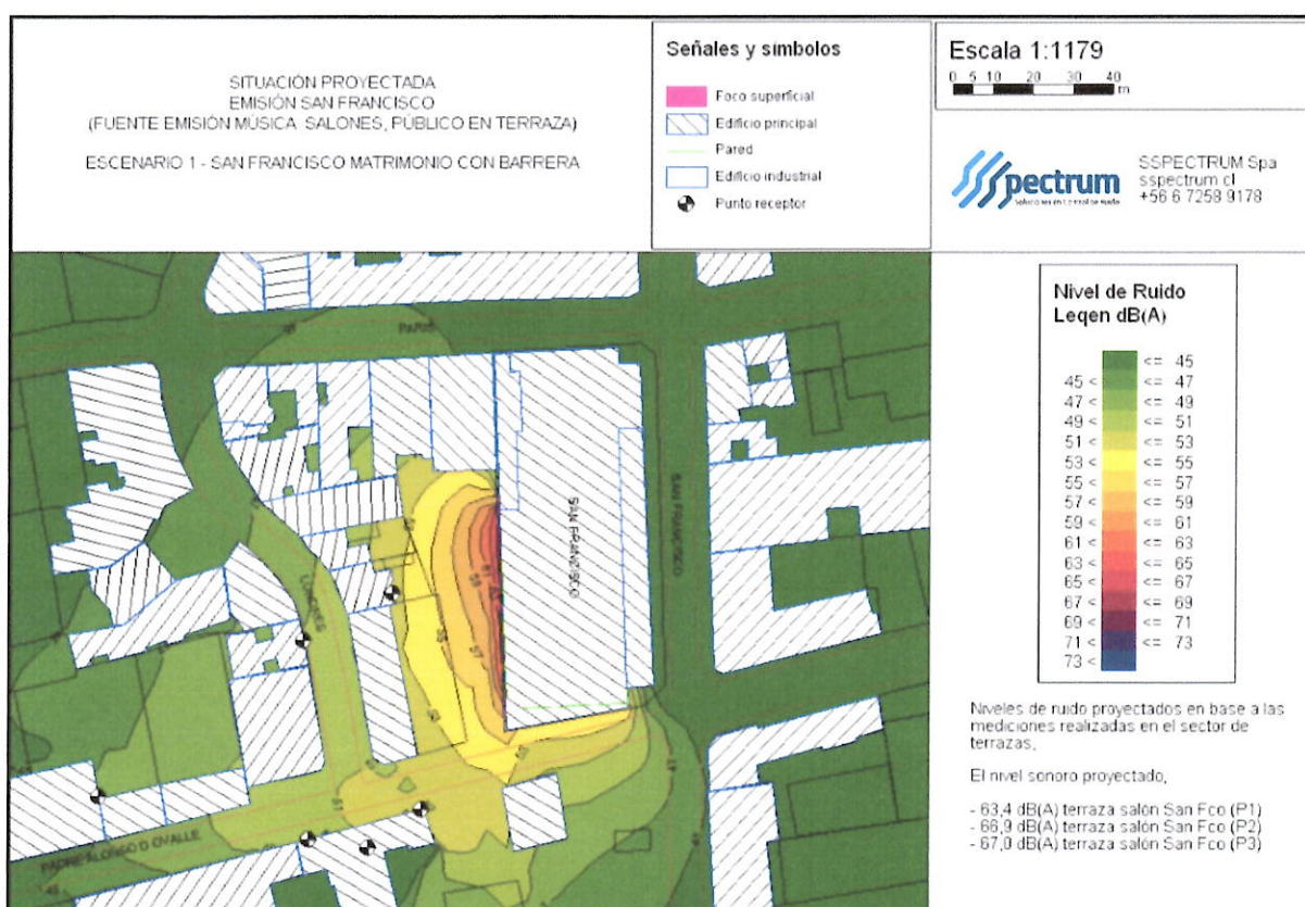
Ilustración 10: Mapa de ruido escenario 1 con barrera – Funcionamiento Alto San Francisco con barrera 2,4 m.
