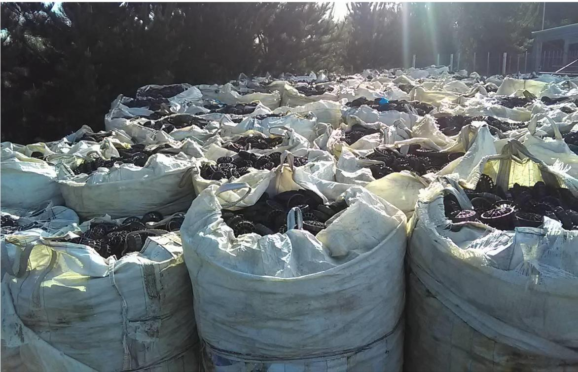
Figura 12: Tricking Media Filter Pack para reactor aeróbico
