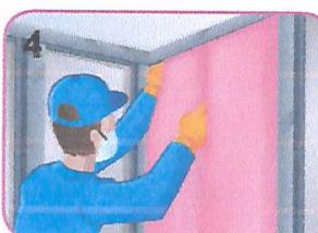
Procure cubrir bien con aislante de extremo a extremo sin dejar espacios vacíos, comprimido sin arrugas, para garantizar óptima resistencia térmica y efectividad acústica.
