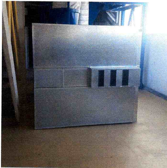
Figura 1. Encierro Acústico típico con accesos.
