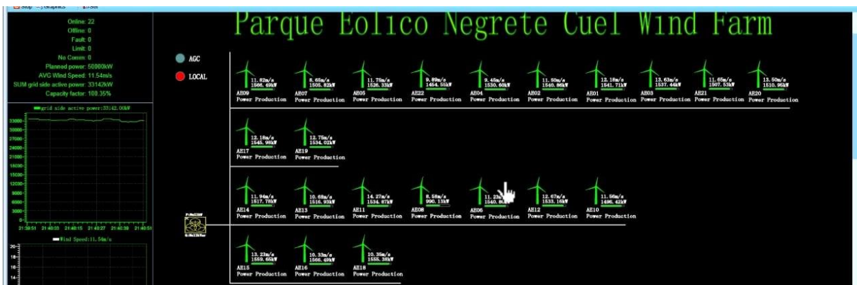
Figura 2: Panel de Sistema SCADA
