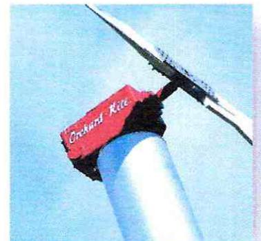
**Hélice de cinco aspas.** Las máquinas de viento mueven grandes volúmenes de aire, protegiendo el predio frente a las heladas. La hélice de dos aspas es la más eficiente, moviendo la mayor cantidad de aire para una potencia determinada, pero este tipo de hélice produce ruido al realizar su trabajo. Para enfrentar esta situación Orchard-Rite ha desarrollado una hélice de cinco aspas, que genera menos ruido y que carece de tonalidad.
