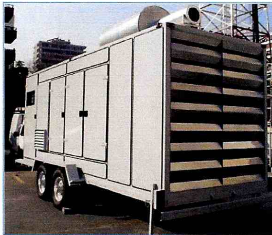
Figura 4. Diseño realizado para grupo generador móvil.
