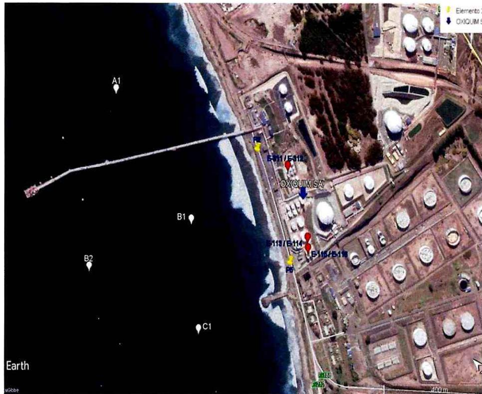
En la figura anterior, se destacan las cámaras recolectoras de aguas lluvias, P2 y P5, donde llegan las aguas lluvias, que son drenadas, previo análisis y autorización, desde el pretil de los estanques E-311 y E-312 (ubicado al Norte del Terminal) y desde el pretil de E-113, E-114, E-115 y E-116 (ubicado al Sur del Terminal), respectivamente. Estas cámaras están ubicadas en el perímetro Oeste del Terminal, colindante con el Camino Costero, cuyas válvulas se mantienen normalmente
