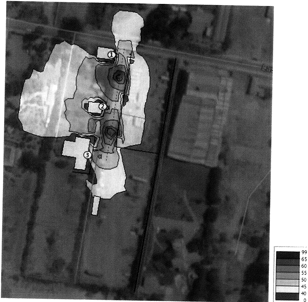
Fig. 3: Mapa de emisión de ruido desde el interior del estacionamiento de buses hacia los puntos receptores, implementando pantallas acústicas provisionarias en los puntos receptores.
