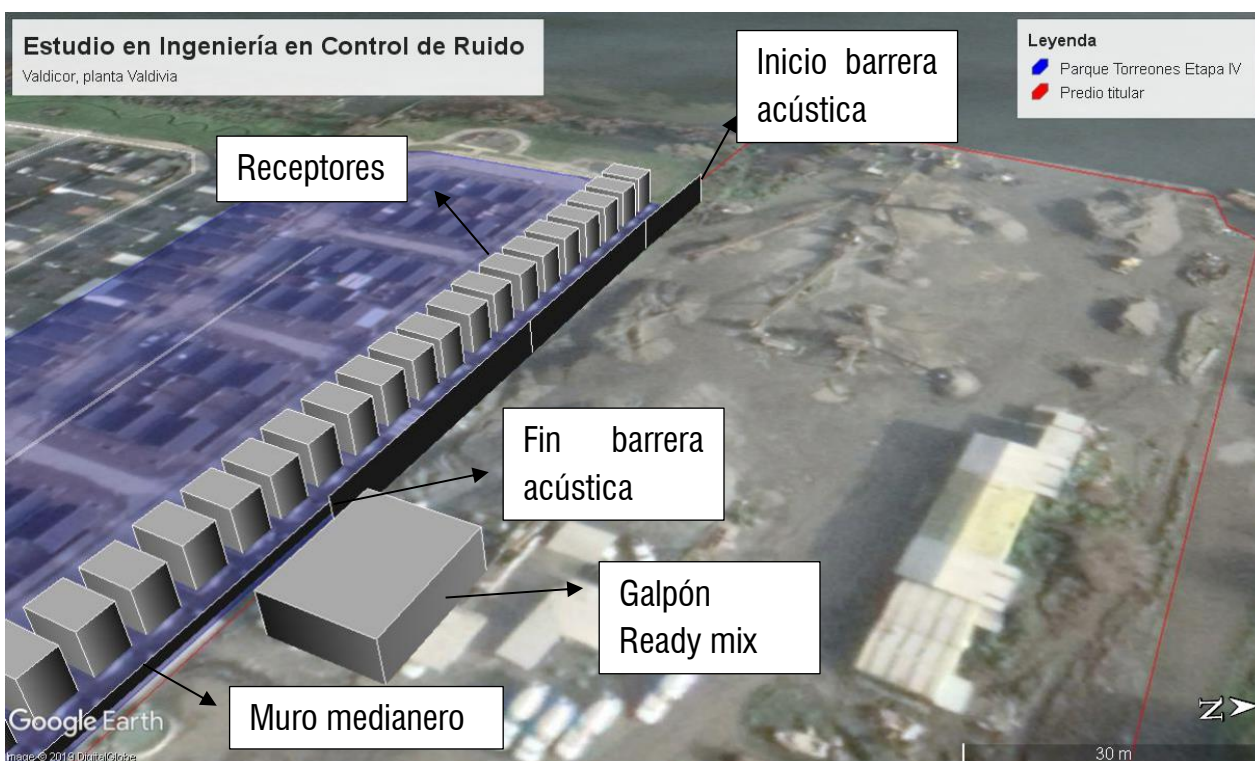
Figura 24. Ubicación de barrera acústica perimetral en Proyecto.
