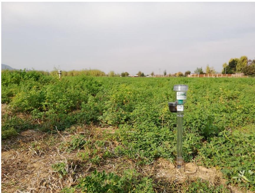
Foto N° 3: Sector cultivo alfalfa y tensiómetro para el manejo de la capacidad de campo.
