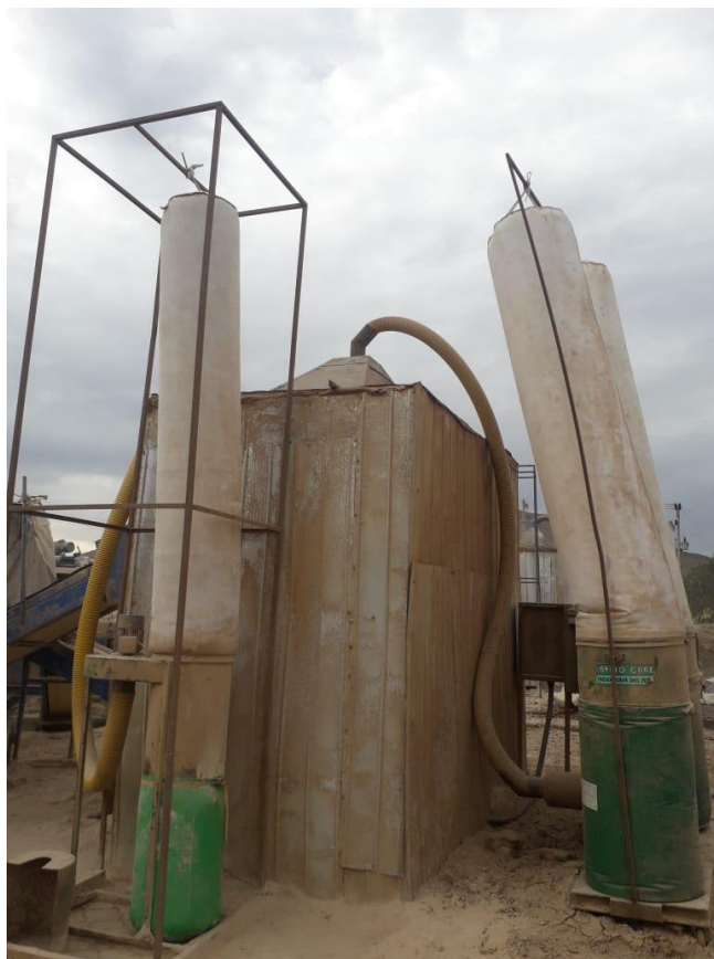
CASETA DE ENCAPSULAMIENTO MOLINO REFINADOR Nº 1
