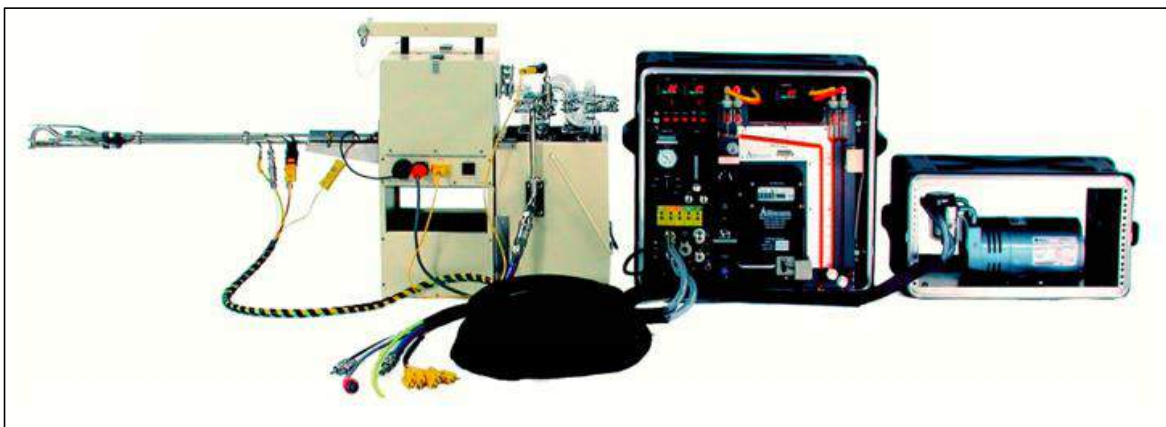
Figura N° 2 Foto referencial de tren de muestreo isocinético
