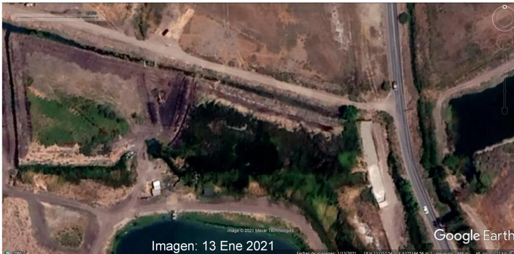
**Figura N°3.1:** Se observa en imagen Google Earth del 13 enero 2021, operación para la construcción de piscina artificial para almacenar las aguas a ser captadas desde el estero Sin Nombre.
