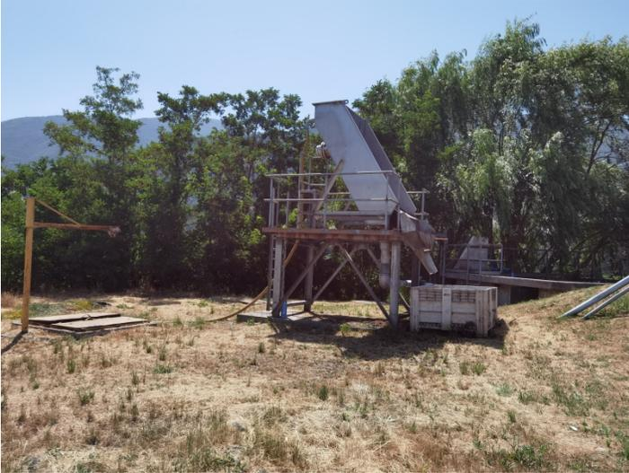
Imagen 6: Hidrolavadora para limpieza del filtro parabólico:
