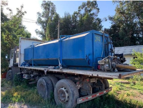
Ilustración 1. Camión con estanque y bomba para succión y riego de pilas
