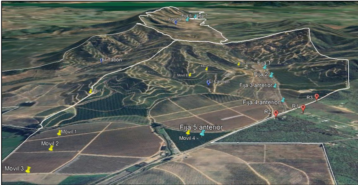
Imagen N° 4: Esquema operativo original de control de heladas, con incorporación de la geografía y relieve existente y referencia de los receptores de emisiones sonoras R1, R2 y R3. (Posiciones meramente referenciales para torres móviles). Fuente: Elaboración propia.
