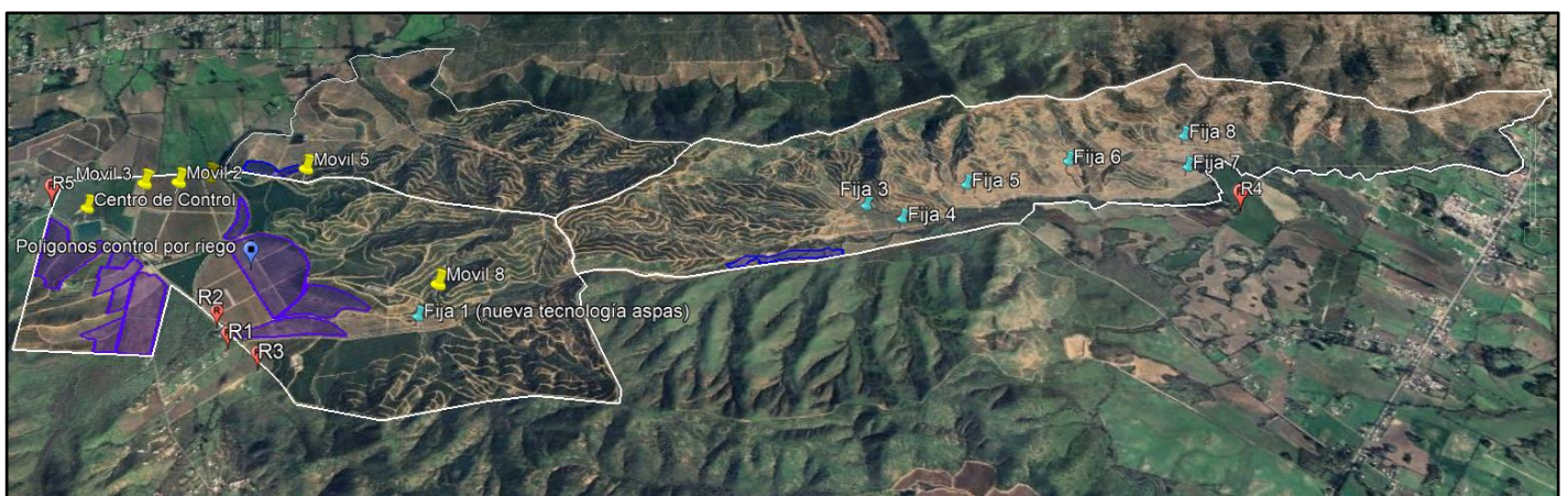
Imagen N° 5: Nuevo esquema operativo de control de heladas, con referencia de los receptores de emisiones sonoras R1, R2 y R3 y nuevos receptores R4 y R5. El sistema de control mediante riego corresponde a los polígonos de color azul. Fuente: Elaboración propia.
