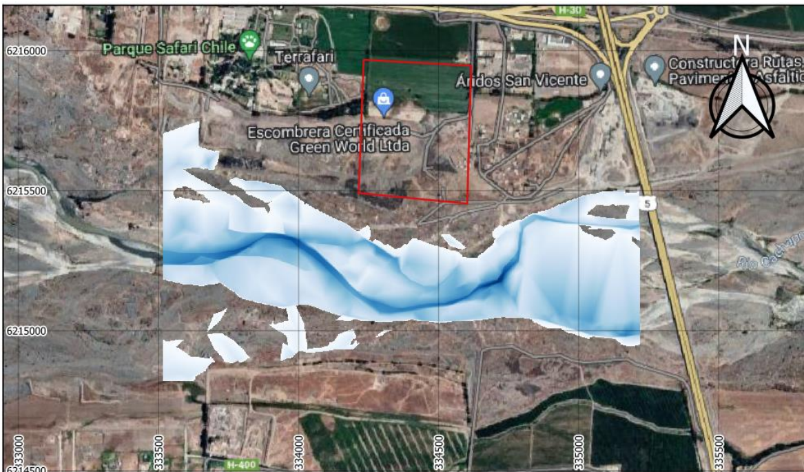
Figura 4. Ortofoto con limite predial y lamina de inundación periodo de retorno T=5 años.
