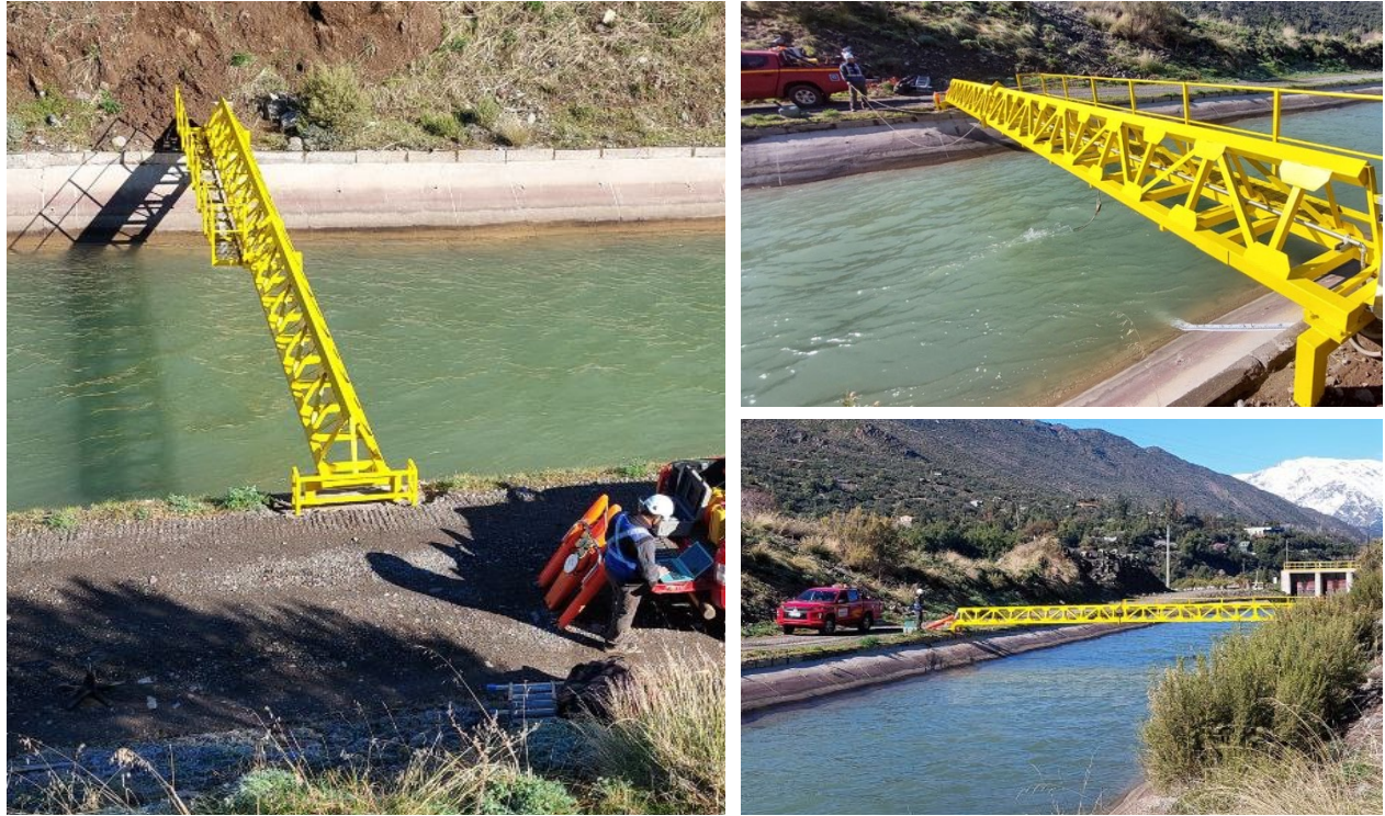
Figura 2.5. Procedimiento de aforo en el canal Guayacán.
