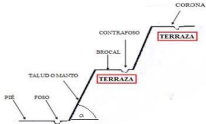
Figura 3. Esquema diseño de contrafosos
