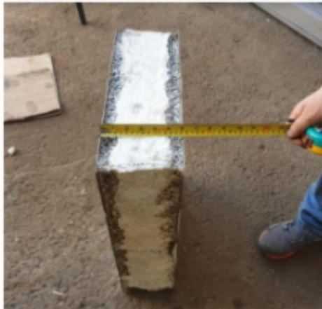
Material instalado en muro, con aislante de poliuretano
