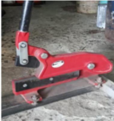
Adquisición de una guillotina cortadora de fierros, para disminución de uso de galletera. (valor compra guillotina \$ 280.000)
